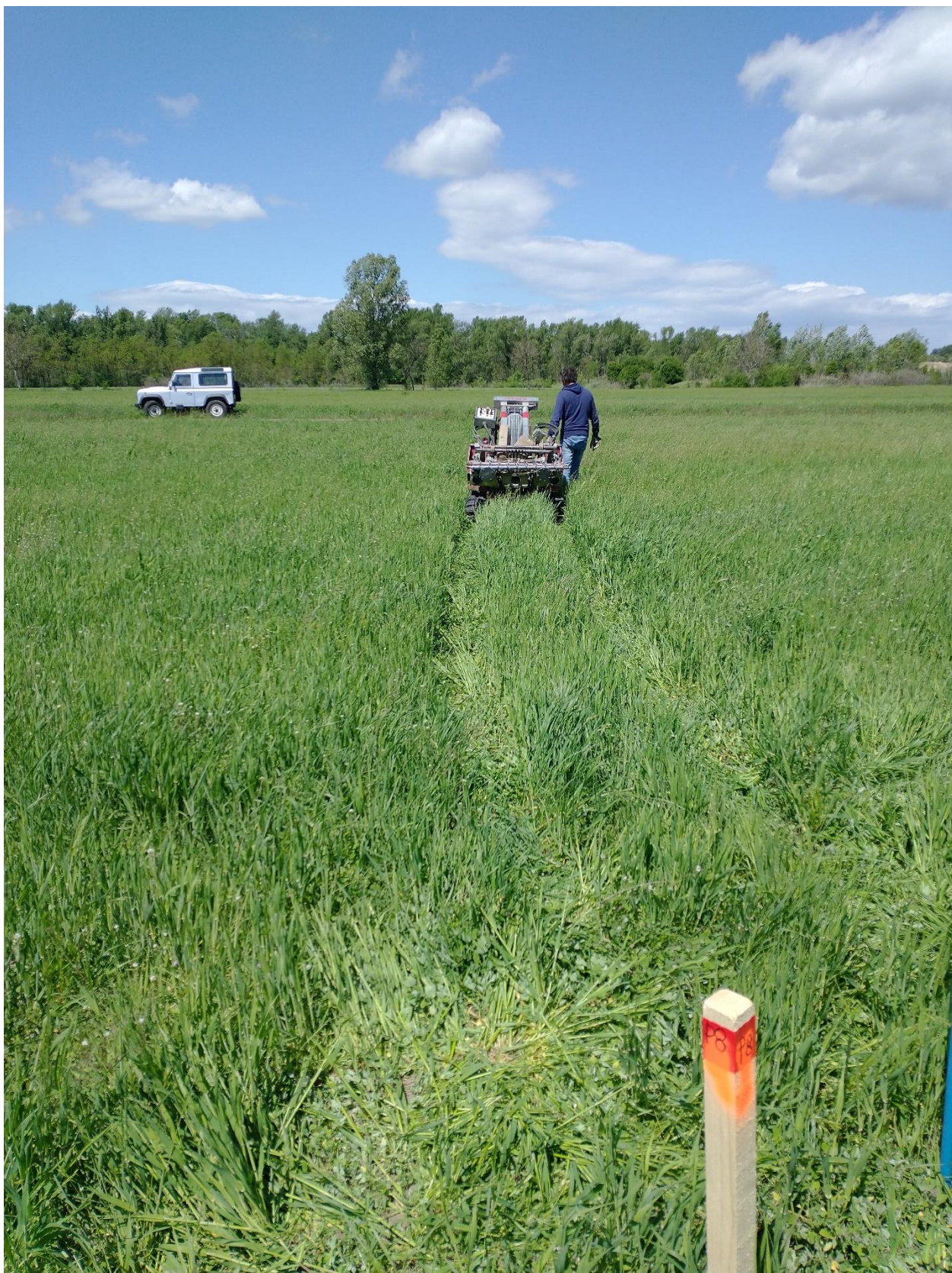
Foto n 10 – scpt 8 - con installazione piezometro (tubo azzurro a margine destro)
